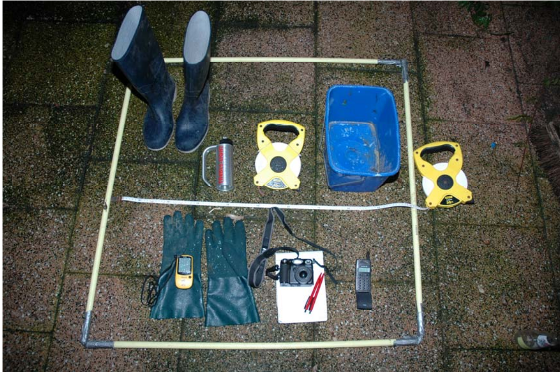
Figuur 6. Benodigde materialen: opklapbaar kwadrant van 1 x 1 meter, laarzen, (duik)lamp, meelint, emmertje, handschoenen, GPS, fotocamera, PIMP-formulieren en mobiele telefoon.
